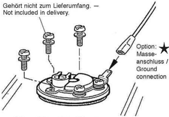
Einbau-Ø / Installation Dia.: 41 mm
