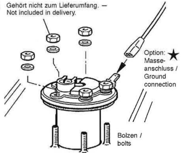
Einbau-Ø / Installation Dia.: 41 mm
